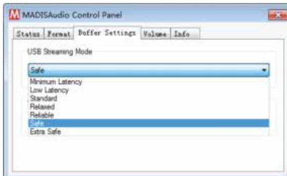
和音频流的缓存大小。音频缓冲区的数量和/或大小可以阻止音频信号分裂，但也会增加延迟，即输出被延迟。
