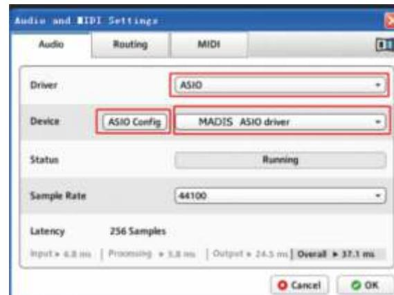
点击 ASIO Config 可以打开 ASIO 驱动的控制面板，对 ASIO 的一些参数进行设置。
